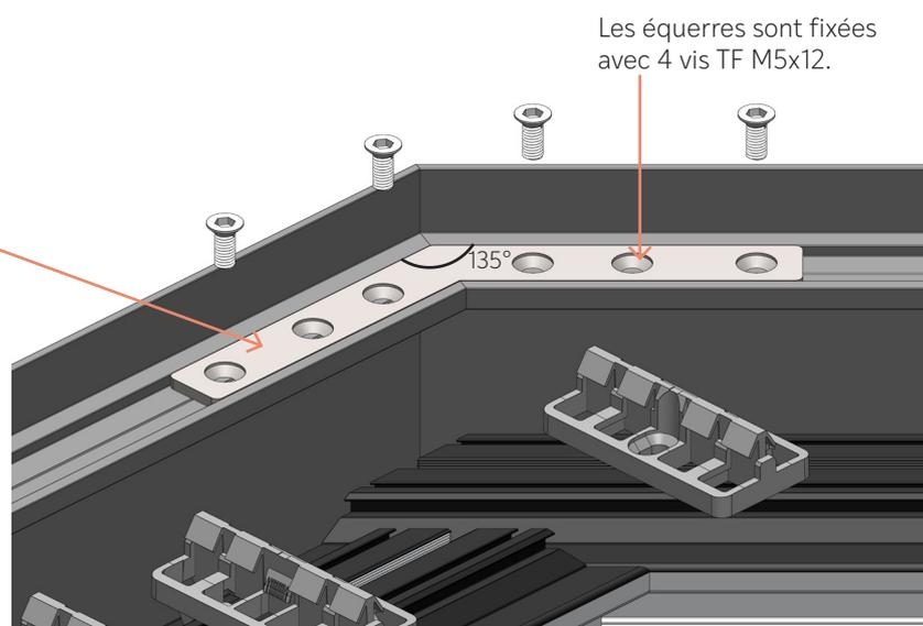
Les trous sont chanfreinés pour noyer les têtes de vis afin d'éviter les collisions avec le platelage.
